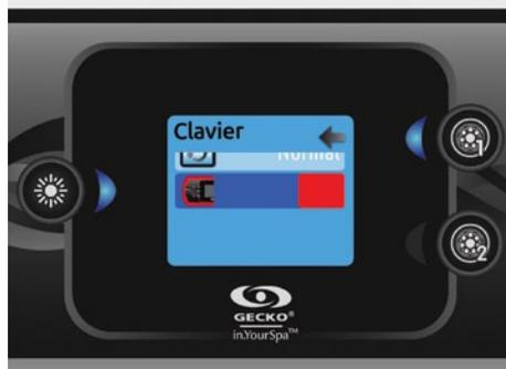
**Note: Avec le in.k500 équipé du module sélection de couleur de contour: Si l'option « Rétroéclairage RGB » est activée dans la configuration du spa, une nouvelle option s'affichera pour permettre de choisir la couleur de la lumière du contour.**
